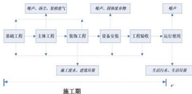
图 2-2 施工期工艺流程及产污环节图
