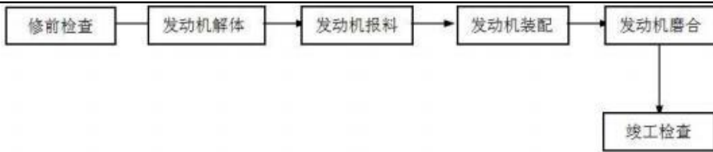
图 2-3 发动机修理工艺流程图
